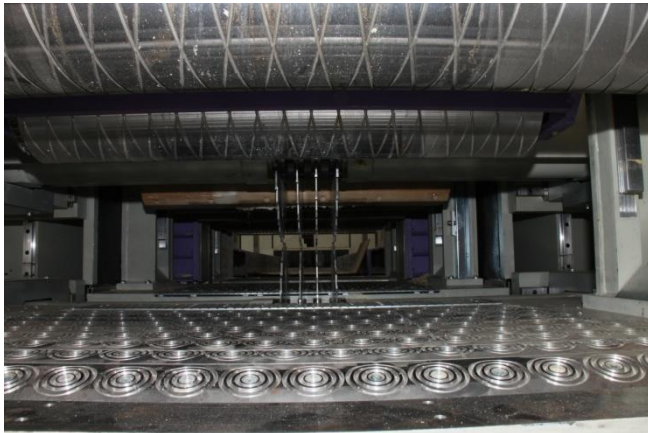
Bild 2: Kettentransportband, vollflächige Auflage, in der Mitte die Sägeblätter in doppelwelligiger Position
