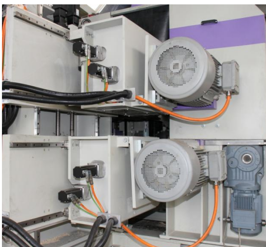
Bild 4: Zwei Sägeaggregate auf Schlitten, geführt auf Linearführungen und Verstellung über Servomotoren
